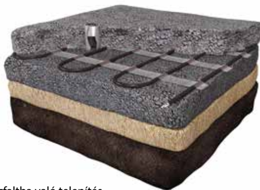
Aszfaltba való telepítés
